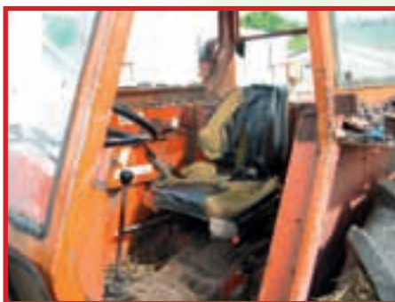
De trillingen geproduceerd door een rijdende machine worden verergerd indien de bestuurdersplaats en de ophanging van het voertuig verouderd zijn.
